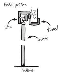
Posuvný systém na **tunel**
