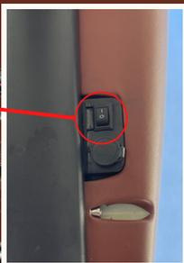
La batterie se charge uniquement sur le vélo. Elle n'est pas démontable. Vous pouvez néanmoins allumer ou éteindre la batterie avec ce bouton ON/OFF
