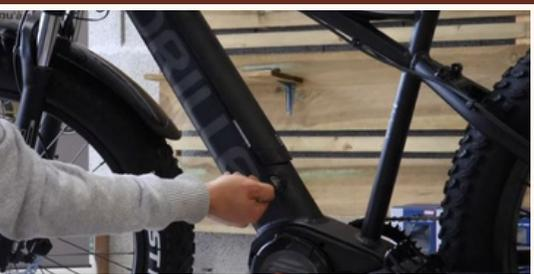
Si besoin, pour retirer la batterie, poussez sur la clé et tournez dans le sens anti-horaire jusqu'à entendre "CLICK".
