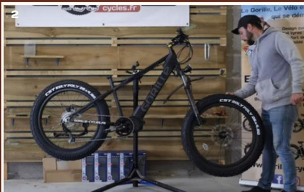
3 - Insérez l'axe de roue avant de part en part de la fourche, puis vissez. Finalisez ensuite le serrage avec la goupille.
